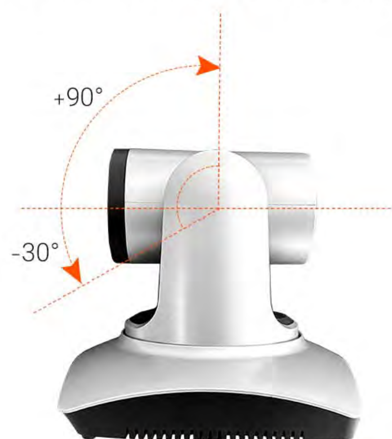
زاویه چرخش عمودی لنز 120°
